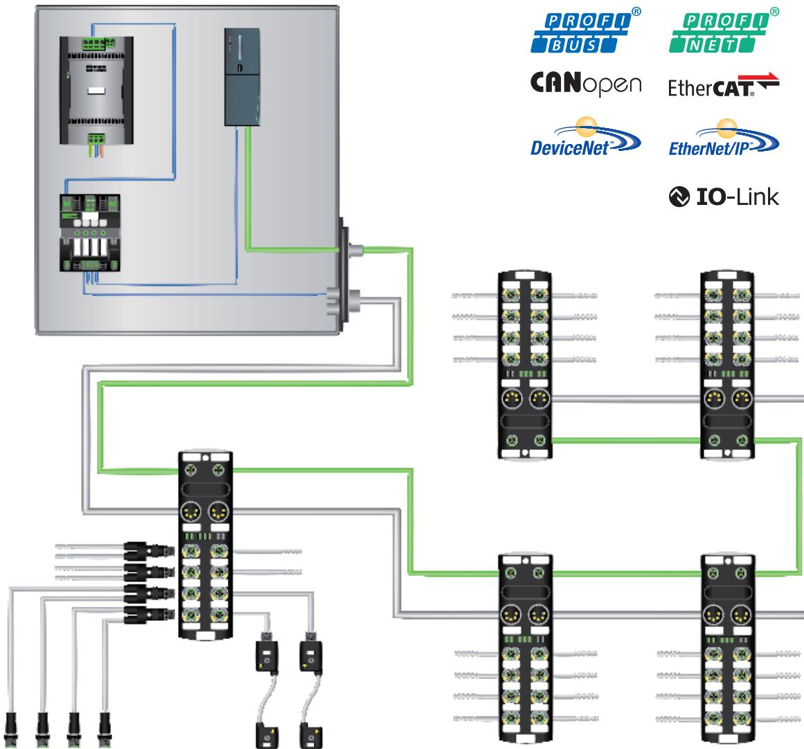
基礎現場總線使用少量的佈線，並且不需要設定參數，提供優秀的診斷支援和故障排除能力。全面使用預製連接器，大幅度減少安裝時間及配線錯誤風險。
