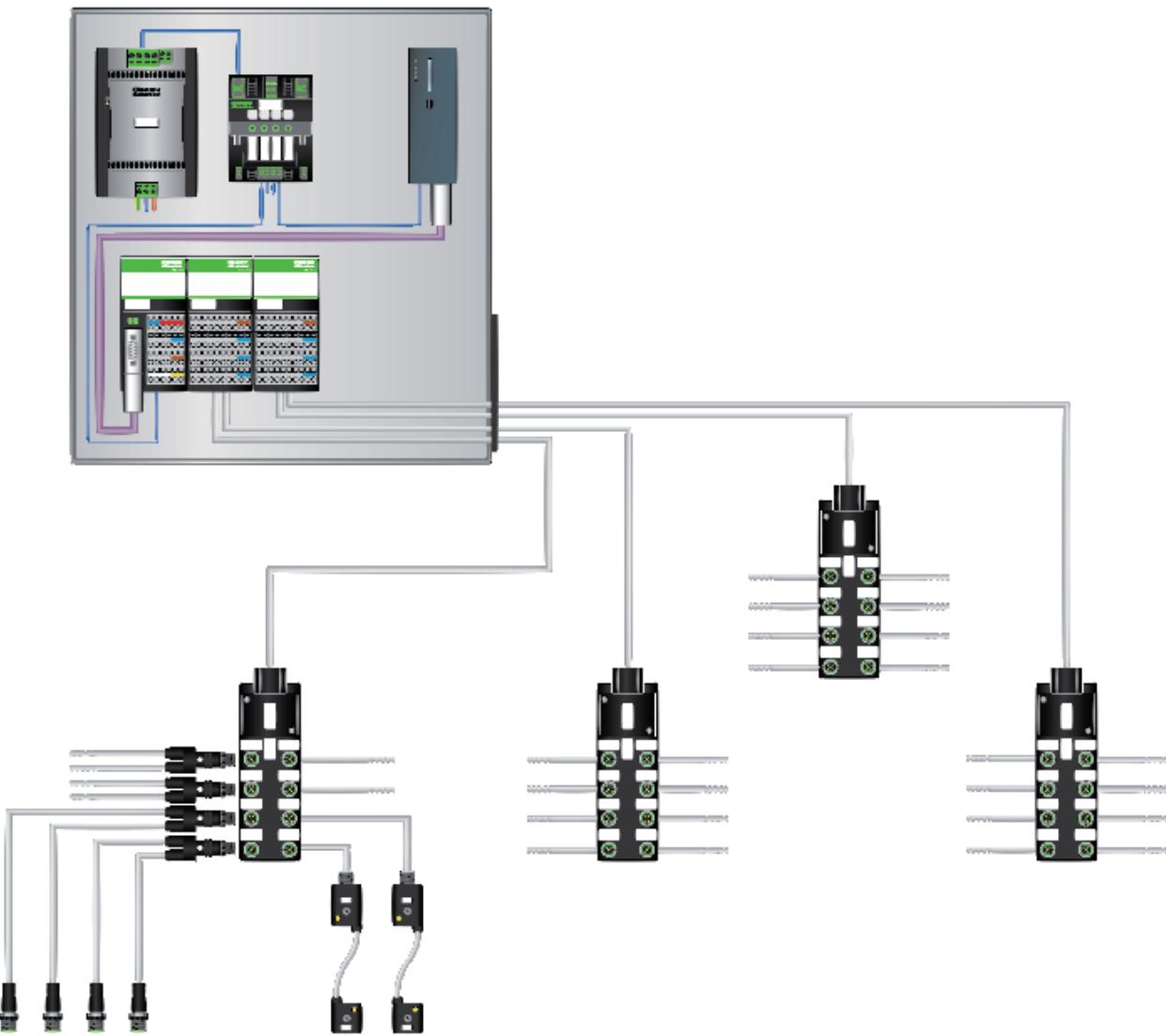
集線盒通過使用預製連接器來優化I / O和控制箱的接線，每個集線盒提供少量的接點與I/O元件連接，而集線盒上的LED提供I / O的狀態識別以便於故障排除。採用此方式的配線錯誤風險較接線盒配線方式低。
