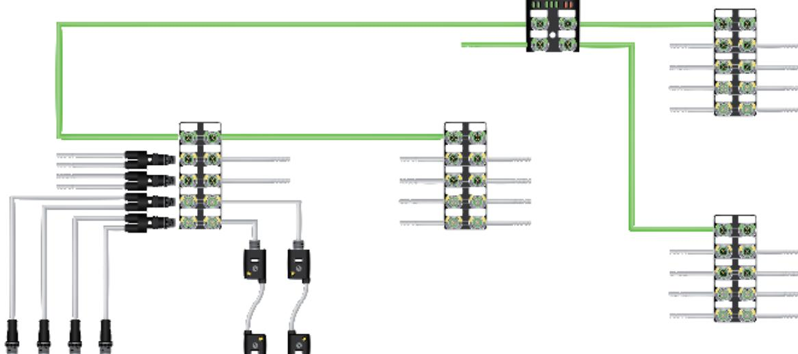
模組化現場總線的佈線量更少，而且在規劃和擴充系統時，提供最大的靈活度；具有強大的診斷與電路保護功能，在智慧機械中提供I/O做預防保養及快速查修時的相關資訊。全面使用預製連接器，大幅度減少安裝時間及配線錯誤風險。
